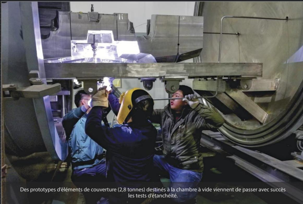
Des prototypes d'éléments de couverture (2,8 tonnes) destinés à la chambre à vide viennent de passer avec succès les tests d'étanchéité.
