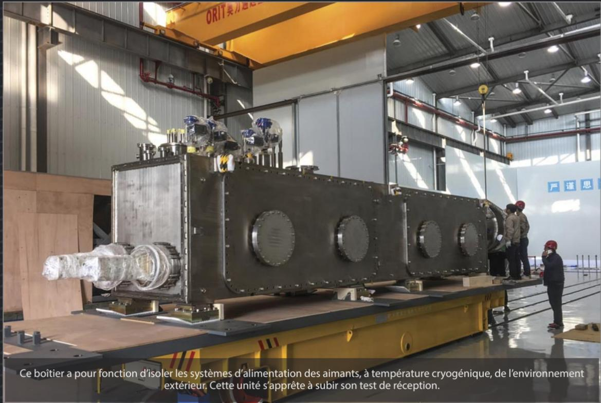
Ce boîtier a pour fonction d'isoler les systèmes d'alimentation des aimants, à température cryogénique, de l'environnement extérieur. Cette unité s'apprête à subir son test de réception.
