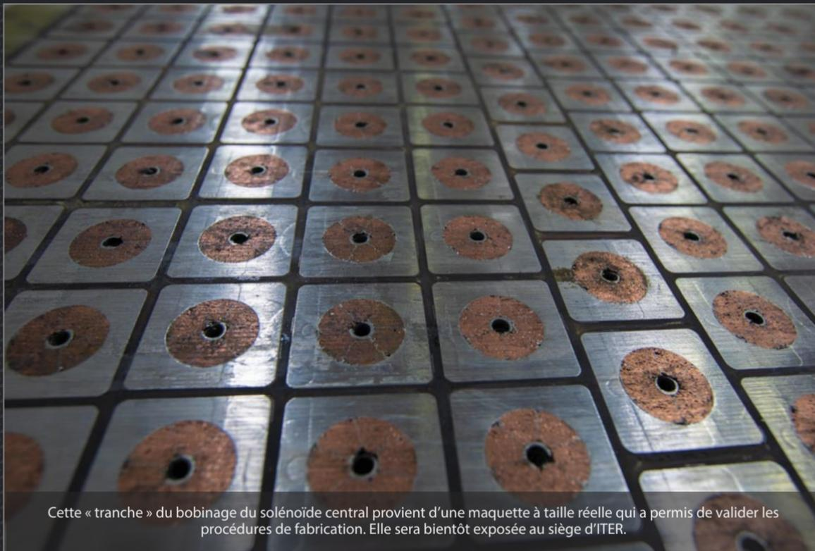
Cette « tranche » du bobinage du solénoïde central provient d'une maquette à taille réelle qui a permis de valider les procédures de fabrication. Elle sera bientôt exposée au siège d'ITER.
