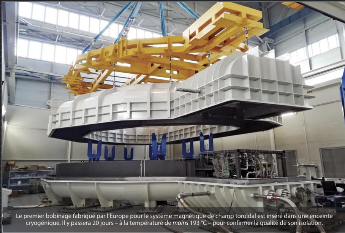
Le premier bobinage fabriqué par l'Europe pour le système magnétique de champ toroïdal est inséré dans une enceinte cryogénique. Il y passera 20 jours – à la température de *moins* 193 °C – pour confirmer la qualité de son isolation.
