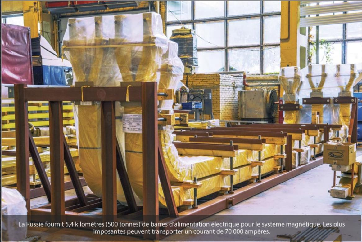
La Russie fournit 5,4 kilomètres (500 tonnes) de barres d'alimentation électrique pour le système magnétique. Les plus imposantes peuvent transporter un courant de 70 000 ampères.
