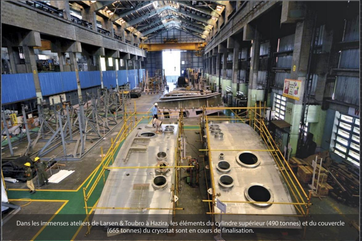
Dans les immenses ateliers de Larsen & Toubro à Hazira, les éléments du cylindre supérieur (490 tonnes) et du couvercle (665 tonnes) du cryostat sont en cours de finalisation.
