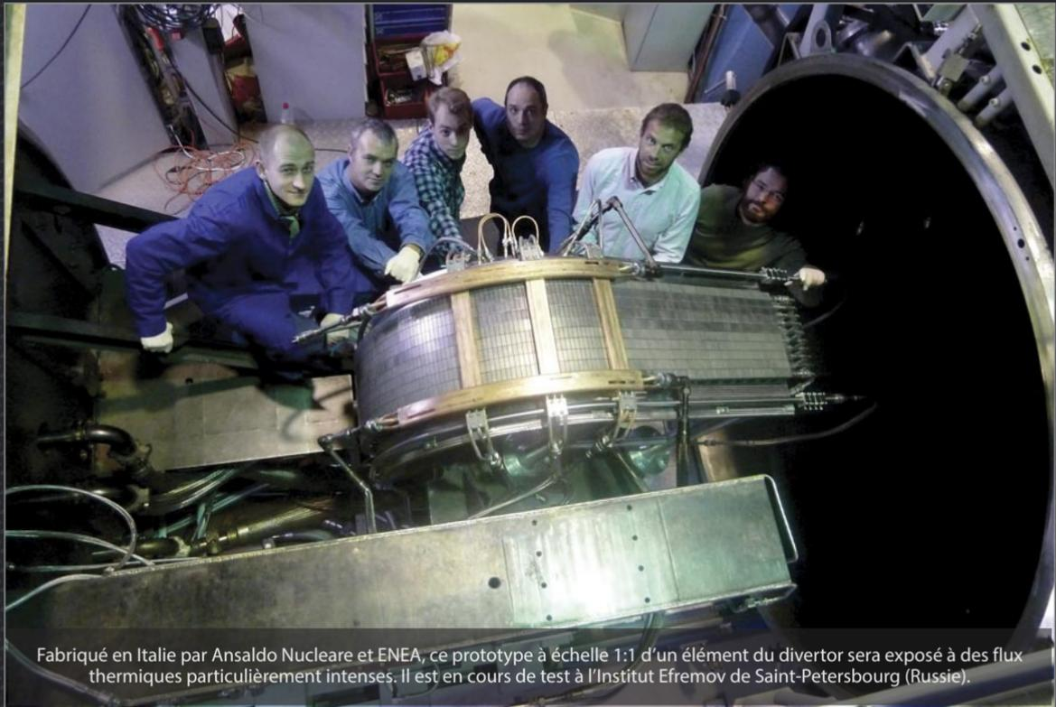
Fabriqué en Italie par Ansaldo Nucleare et ENEA, ce prototype à échelle 1:1 d'un élément du divertor sera exposé à des flux thermiques particulièrement intenses. Il est en cours de test à l'Institut Efremov de Saint-Petersbourg (Russie).
