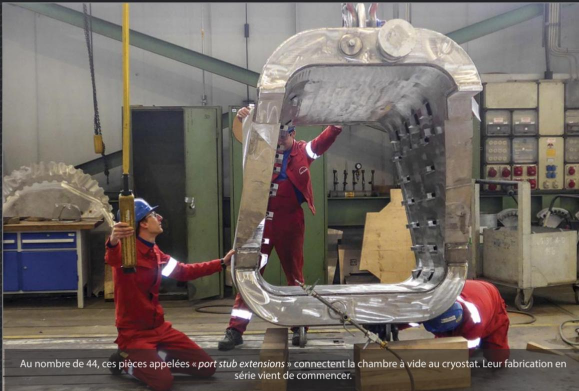
Au nombre de 44, ces pièces appelées « port stub extensions » connectent la chambre à vide au cryostat. Leur fabrication en série vient de commencer.
