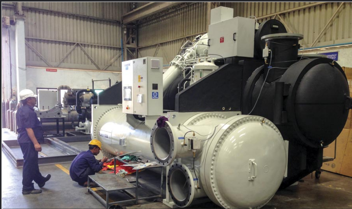
Les éléments du système de refroidissement de la machine sont en cours de fabrication en Inde. Ici, une unité de réfrigération de haute capacité est inspectée avant d'être expédiée vers le site d'ITER.
