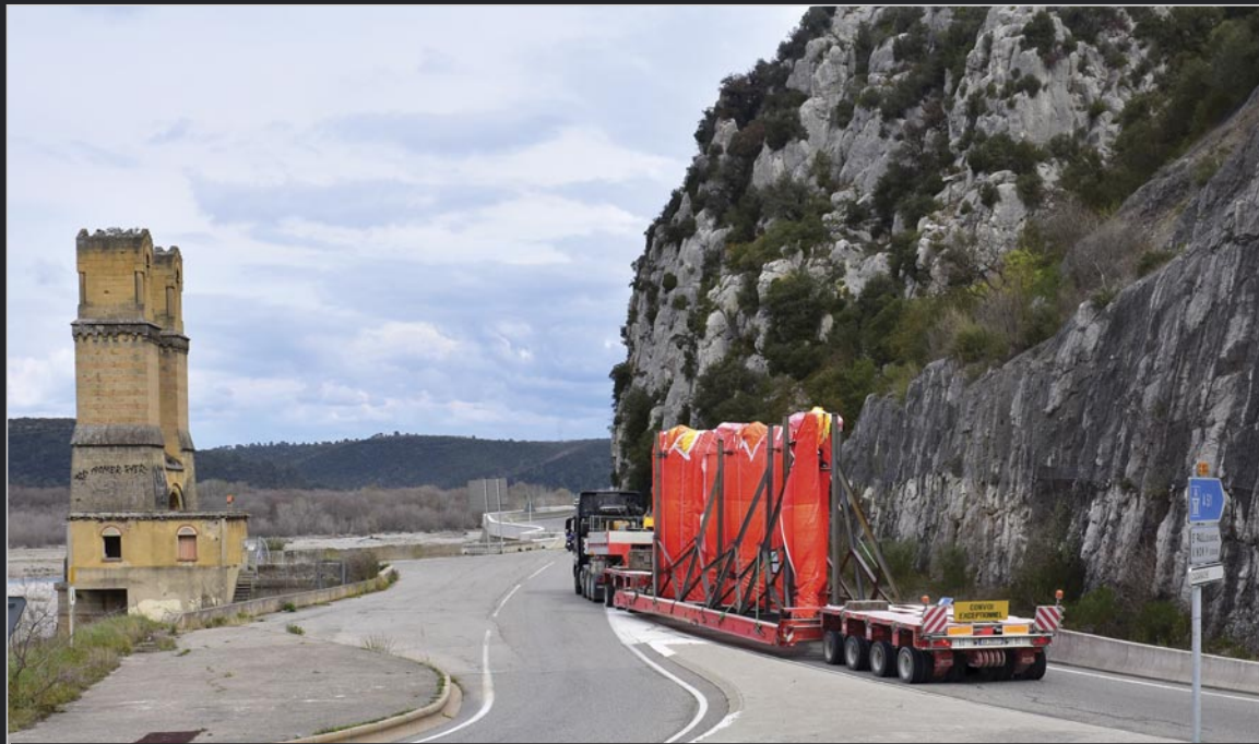
Un « segment » du Cryostat, passe l'étroit défilé de Mirabeau. Fabriqués dans les usines des partenaires d'ITER, la quasi-totalité des pièces de la machine empruntent un itinéraire spécialement aménagé entre le port de Fos-sur-Mer et le site d'ITER. Avril 2017
