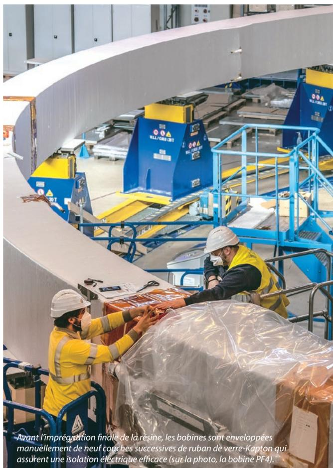
Avant l'imprégnation finale de la résine, les bobines sont enveloppées manuellement de neuf couches successives de ruban de verre-Kapton qui assurent une isolation électrique efficace (sur la photo, la bobine PF4).
