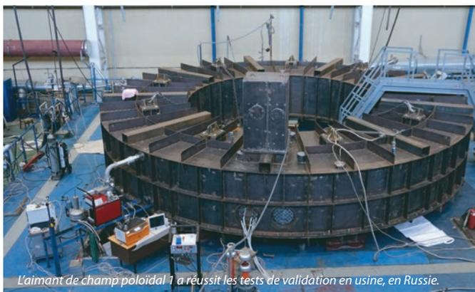
L'aimant de champ poloidal 1 a réussi les tests de validation en usine, en Russie.
