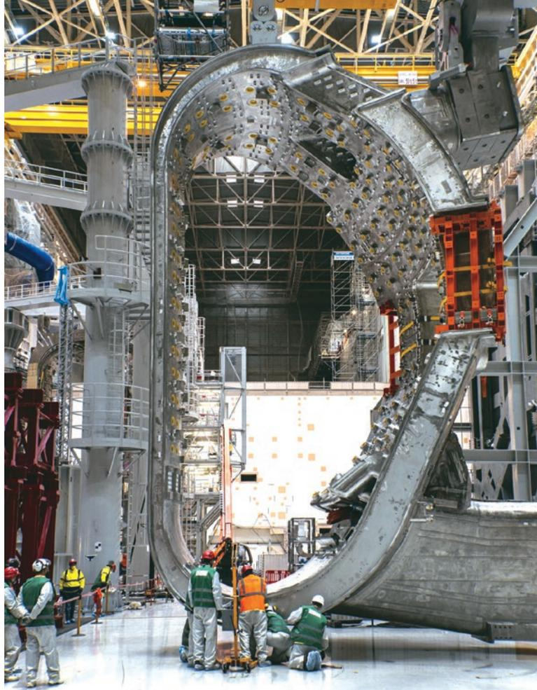
Les écarts apparus pendant le soudage des trois secteurs de la chambre à vide déjà livrés ont généré des « non-conformités » dimensionnelles des enveloppes extérieures, ce qui a modifié la géométrie des surfaces de jonction au niveau desquelles seront soudés les secteurs.
