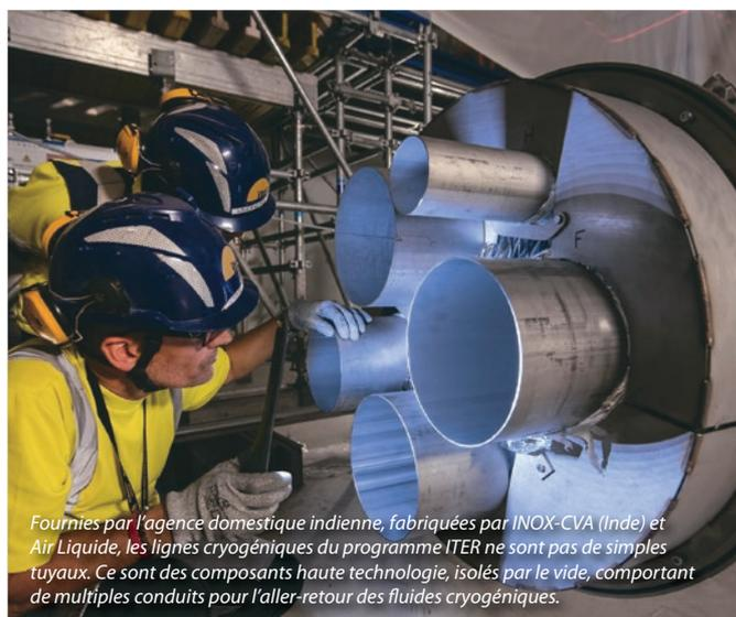
Fournies par l'agence domestique indienne, fabriquées par INOX-CVA (Inde) et Air Liquide, les lignes cryogéniques du programme ITER ne sont pas de simples tuyaux. Ce sont des composants haute technologie, isolés par le vide, comportant de multiples conduits pour l'aller-retour des fluides cryogéniques.
