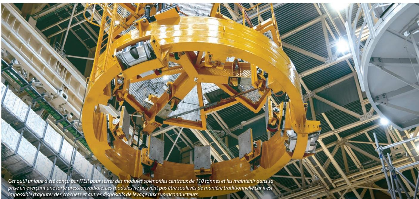
*Cet outil unique a été conçu par ITER pour serrer des modules solénoïdes centraux de 110 tonnes et les maintenir dans sa prise en exerçant une forte pression radiale. Les modules ne peuvent pas être soulevés de manière traditionnelle car il est impossible d'ajouter des crochets et autres dispositifs de levage aux supraconducteurs.*
