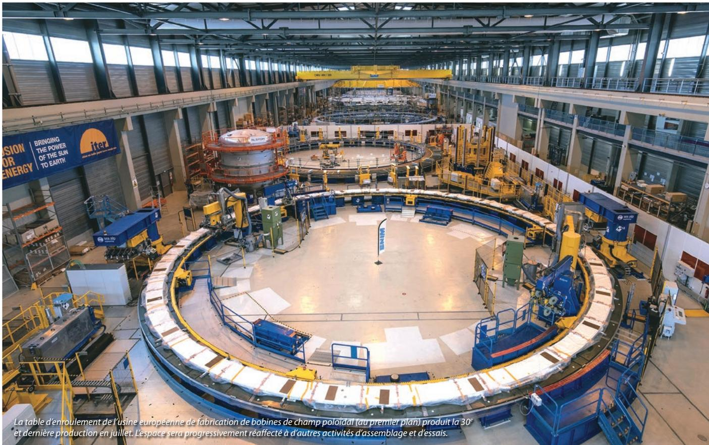
La table d'enroulement de l'usine européenne de fabrication de bobines de champ poloidal (au premier plan) produit la 30<sup>e</sup> et dernière production en juillet. L'espace sera progressivement réaffecté à d'autres activités d'assemblage et d'essais.
