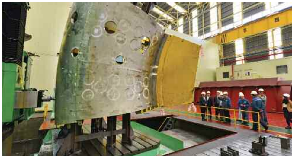
Partie supérieure du segment 6 de la chambre à vide dans l'usine de Hyundai Heavy Industry en Corée. © ITER Organization
