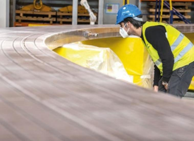
La phase d'imprégnation confère au bobinage isolation électrique et tenue mécanique.
