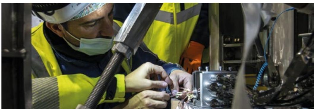
Des équipements de diagnostic sont ajoutés aux bobines de champ toroïdal avant l'assemblage.
