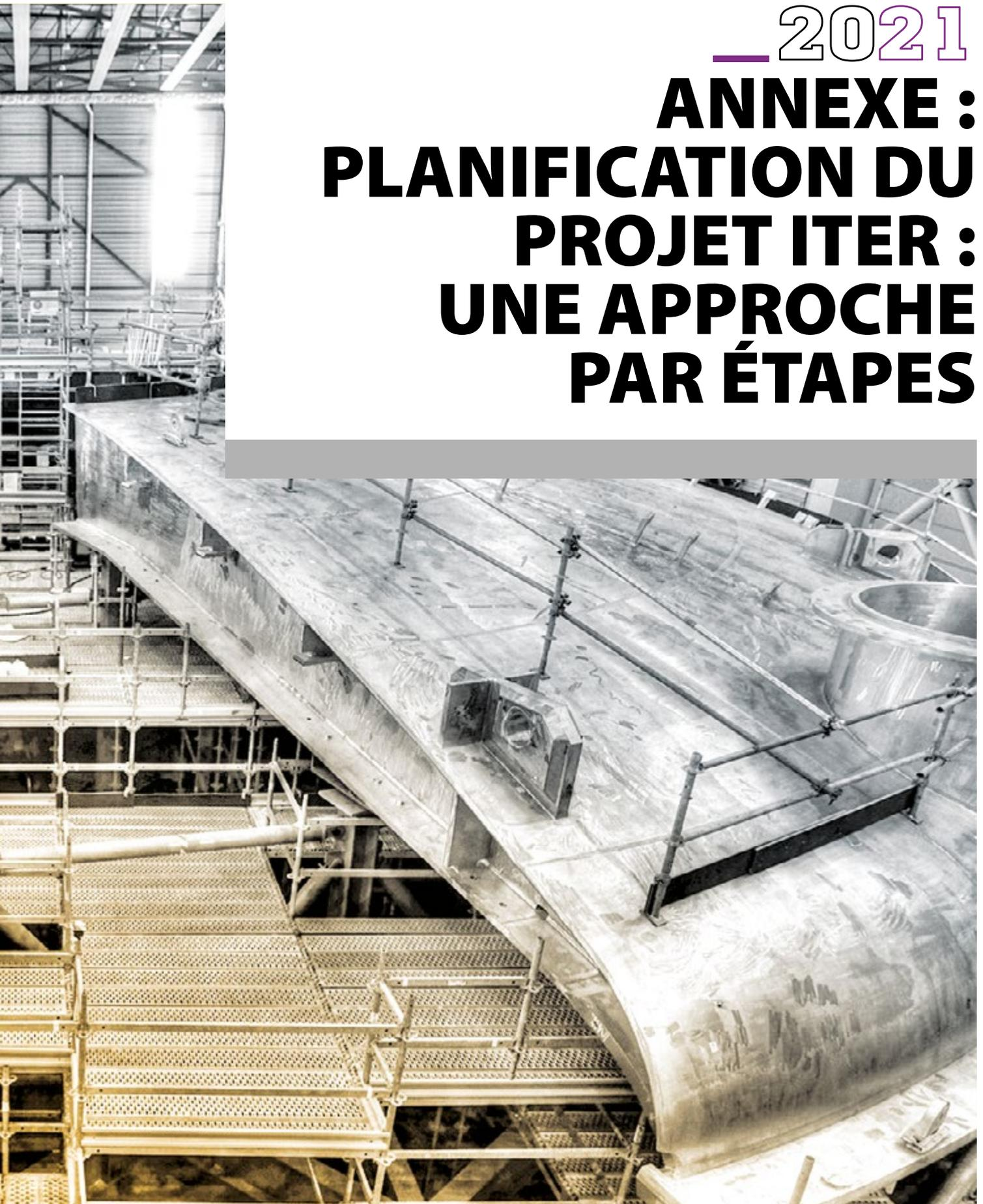
*Le couvercle du cryostat (665 tonnes) est en cours d'assemblage dans l'atelier cryostat. MAN Energy Solutions (sous-traitant de Larsen & Toubro) est en charge du soudage des segments. © Christian Luenig.*
