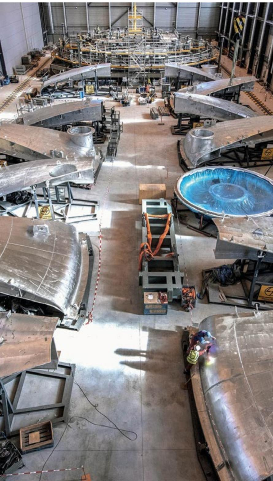
Parfaitement alignés sur le sol de l'Atelier cryostat, les différents segments du couvercle du cryostat (665 tonnes) attendent d'être assemblés. Au fond, la plateforme cache déjà le premier élément-le disque central.
