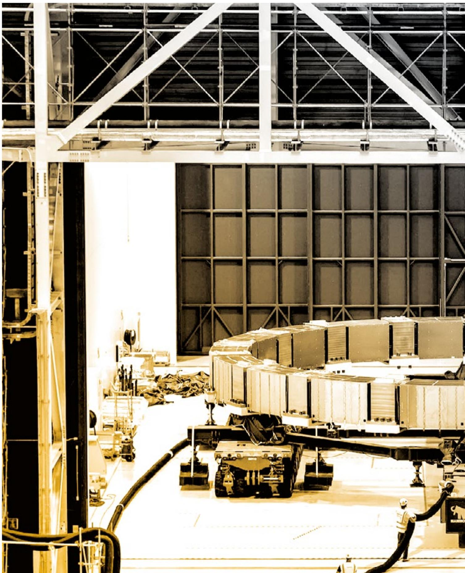
*Fabriquée sur le site d'ITER par l'agence européenne, Fusion for Energy, la bobine poloidale n°5 vient d'entrer dans le Hall d'assemblage. Elle sera installée dans la fosse du tokamak en septembre 2021.*
