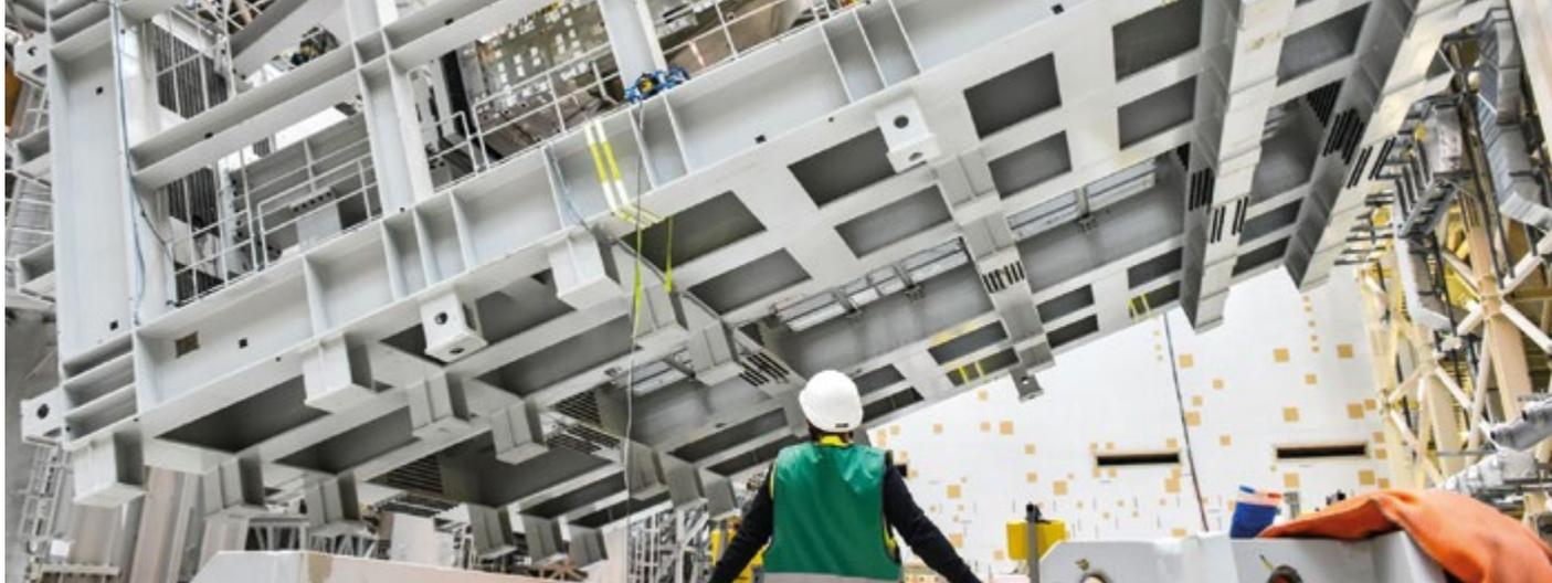
Situé dans le Hall d'assemblage, cet outil de basculement est utilisé pour basculer les composants massifs du tokamak de la position horizontale à la position verticale.
