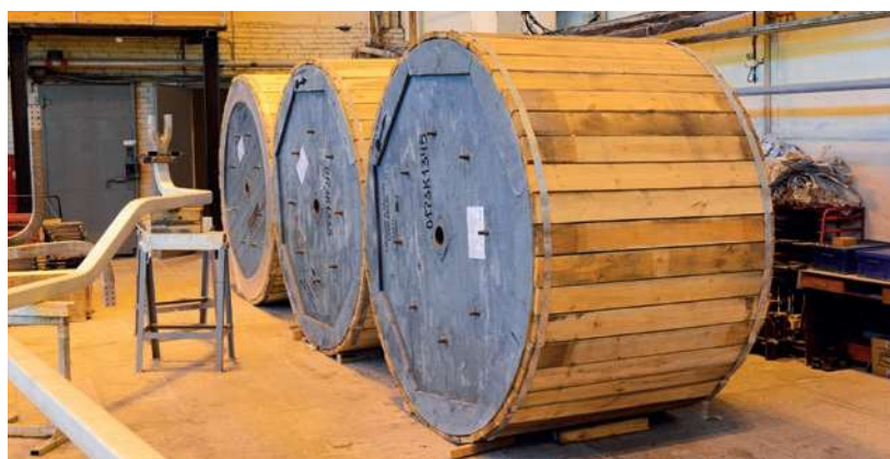
Trente-huit bobines (22 km) de câbles coaxiaux ont été récemment réceptionnées par l'Organisation ITER. Envoyés par la Russie, ces câbles seront intégrés au circuit de décharge des bobines supraconductrices. Juin 2018.
