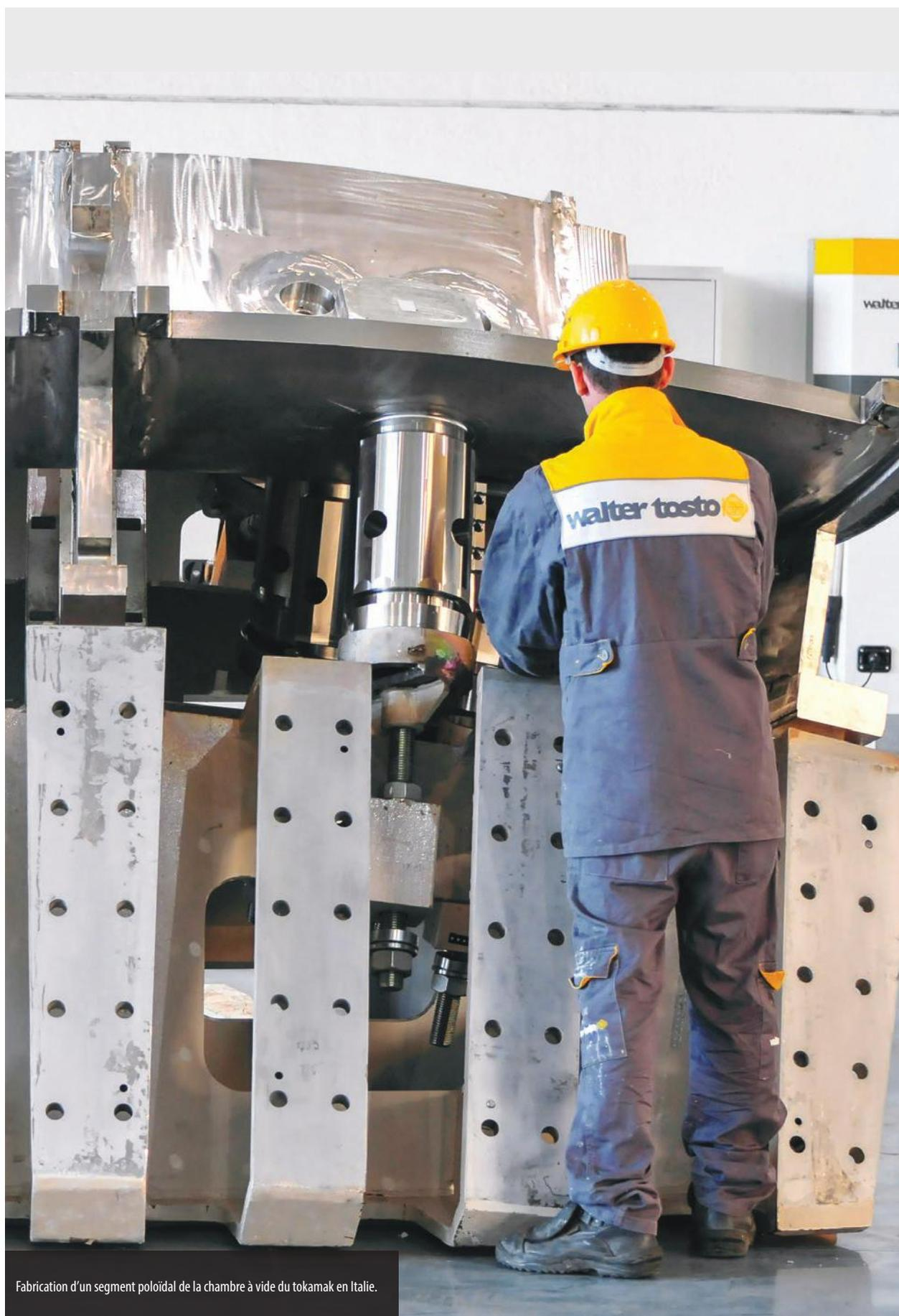
Fabrication d'un segment poloïdal de la chambre à vide du tokamak en Italie.
