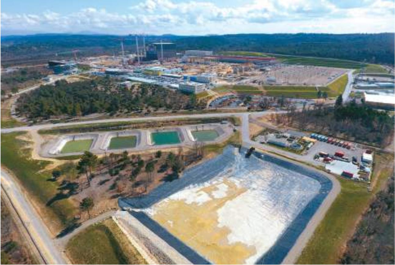
Vue aérienne sur la plateforme, avec au premier plan le grand bassin d'orage, les quatre bassins de contrôle de l'eau du circuit de refroidissement, et à droite la station d'épuration ainsi que la zone de traitement des déchets non nucléaires.
