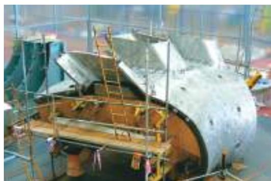
*Fabrication de la chambre à vide du tokamak, à Hyundai Heavy Industries en Corée. Chacun des neuf secteurs de la chambre à vide est constitué de quatre segments, comme celui représenté sur cette photo.*
