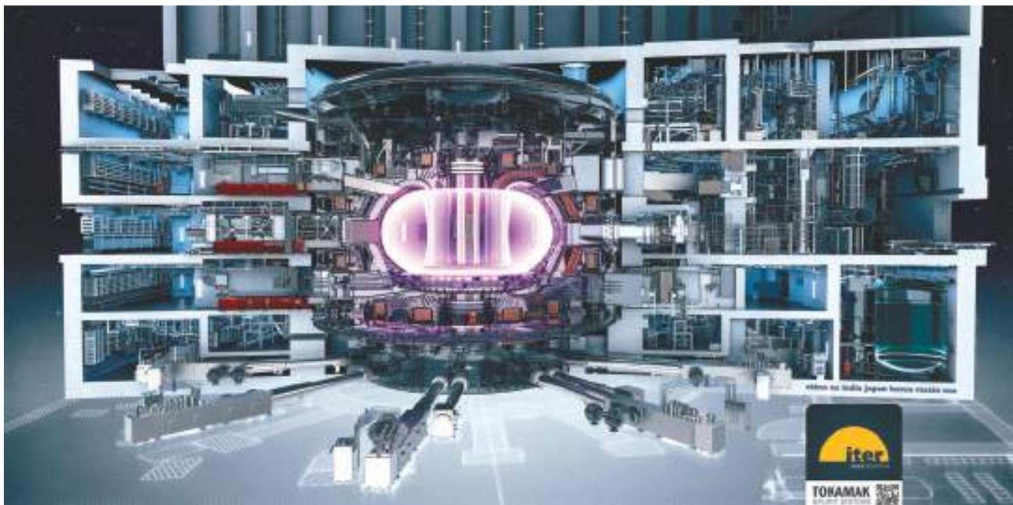
Affiche illustrant une vue éclatée du Complexe tokamak. Au centre le tokamak dans le cryostat. La chambre à vide est illuminée par le plasma.
