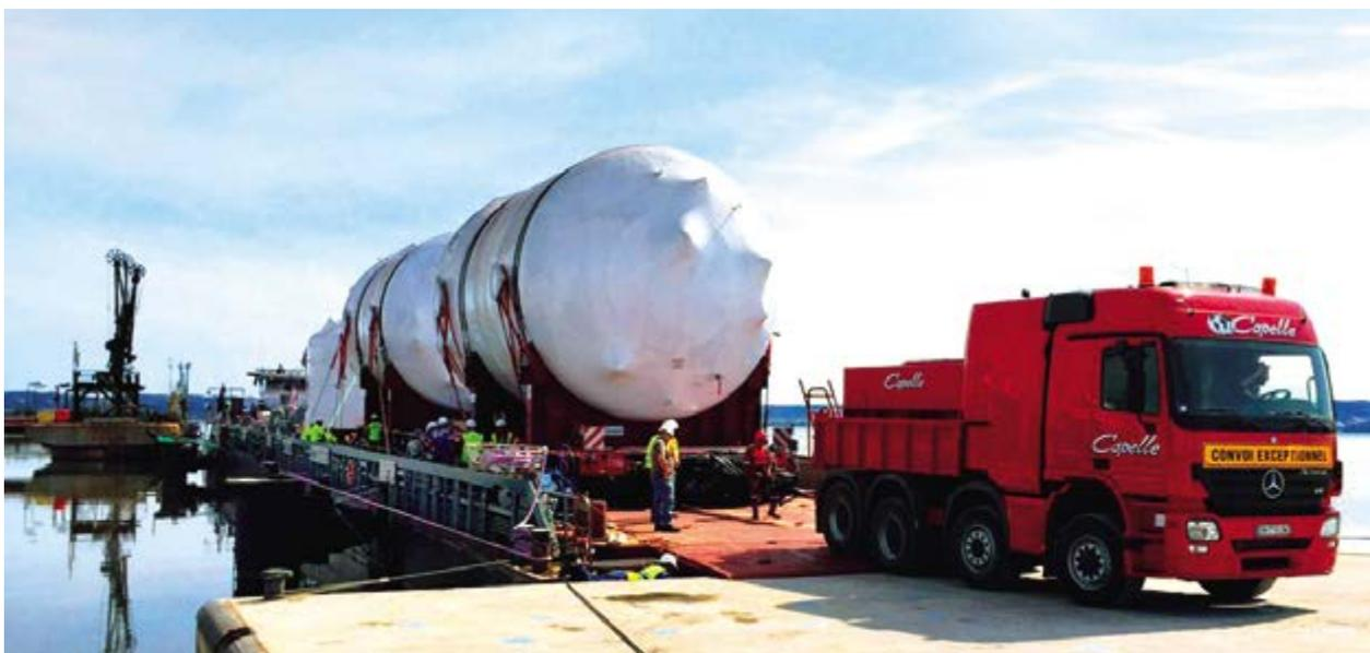
Cinq réservoirs de stockage d'eau du circuit de refroidissement du tokamak ont été livrés sur le site d'ITER en août et en septembre 2015. © F4E
